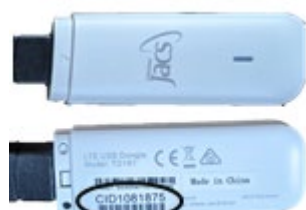
Fig. 1 Imágenes de la parte frontal/parte posterior del adaptador para línea móvil 4G LATITUDE MIMIC; la etiqueta del CID incluye el número de serie.
